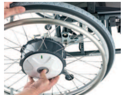
Abnehmen der Antriebsräder per Schnellentriegelung
